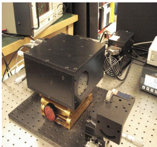
Rys. 24. Blok optyczny układu pomiarowego wykorzystującego metodę PTR wykorzystany w przemyśle. Szczegóły dotyczące budowę układu pomiarowego można znaleźć w pracy [48].
