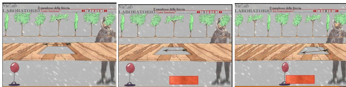
Ryc. 6. Paradoks strzały: a) strzała w spoczynku jest dłuższa niż luka w pomoście; b) z punktu widzenia pomostu, lecąca strzała jest krótsza niż luka w pomoście (miarka na dole) więc przebije balonik, c) z punktu widzenia strzały skraca się luka, ale strzała jest pochylona, więc zmieści się w luce. Można zmieniać prędkość strzały oraz punkt odniesienia (pomost albo strzała).
