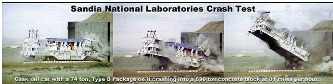
Rys. 3.5 Wagon kolejowy z pojemnikiem typu B o wadze 74 ton uderza z prędkością 130 km/h w blok betonowy o wadze 690 ton. Zdjęcia z testów wykonanych przez Sandia National Laboratories cytowane za pozwoleniem Nuclear Energy Institute (USA).
